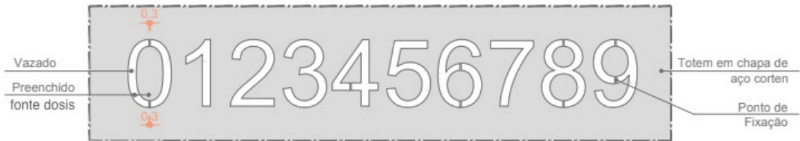
1:10 DETALHE FIXAÇÃO NUMERAÇÃO
